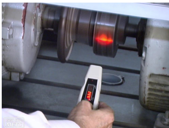
شکل ۸-۲۷: نمایی از نحوه استفاده از تاکومتر غیرتماسی
