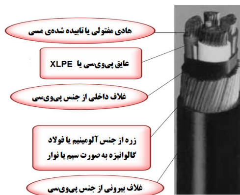
شکل ۳-۴: اجزای یک کابل با عایق پی وی سی
