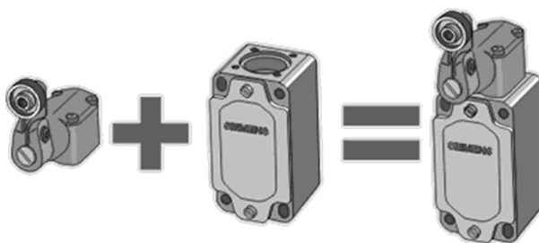
شکل ۷۹-۱: اجزای تشکیل دهنده لیمیت سوئیچ
