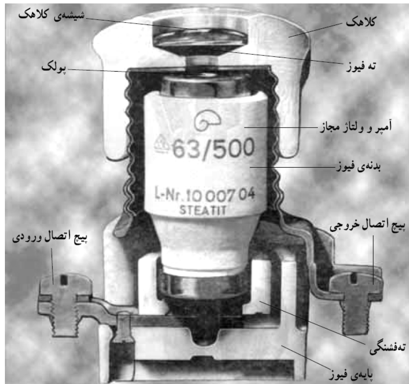
شکل ۱-۴۵: اجزای مختلف یک فیوز
