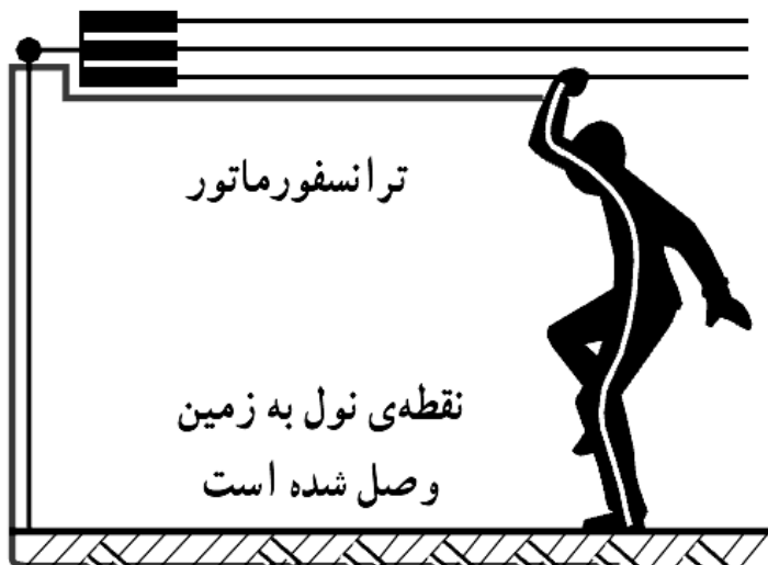
شکل ۲-۴: مسیر عبور جریان برق از بدن شخص برق گرفته
