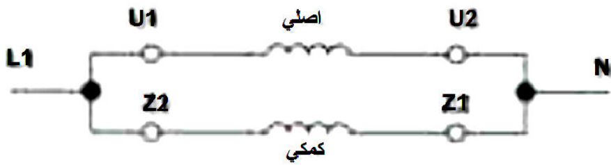
شکل ۲-۴۵: تصویر مدار موتور تک‌فاز در حالت چپ گرد
