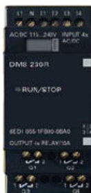
شکل ۶-۷: کارت‌های دیجیتال دارای هشت ورودی و هشت خروجی
