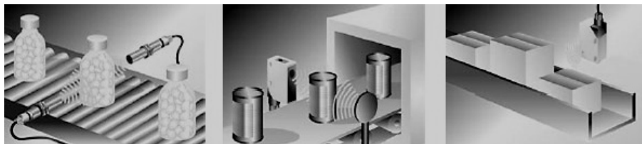
شکل ۱۱۰-۱: نمونه‌ای از عملکرد سنسورهای نوری
