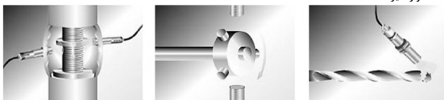
شکل ۹۲-۱: نمونه‌ای از عملکرد یک سنسور القائی
