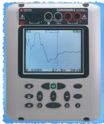
شکل ۳-۹: دستگاه‌های کوچک با استفاده از روش TDR
