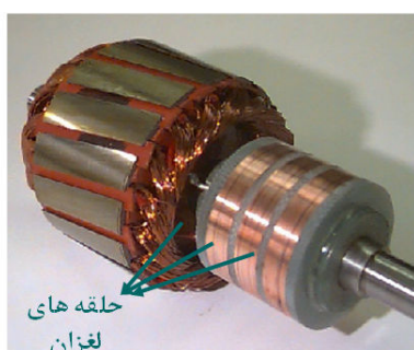
شکل ۸-۲: موتور آسنکرون با روتور سیم‌پیچی
