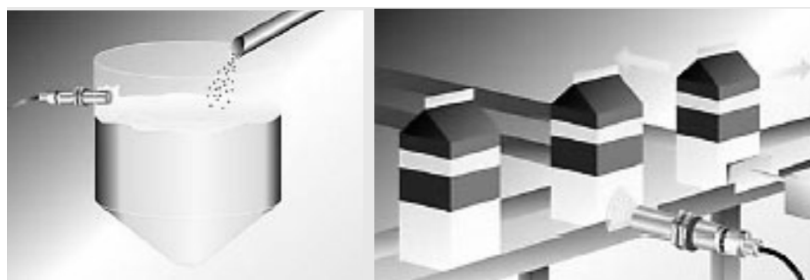
شکل ۹۹-۱: نمونه‌ای از کاربرد سنسورهای خازنی
